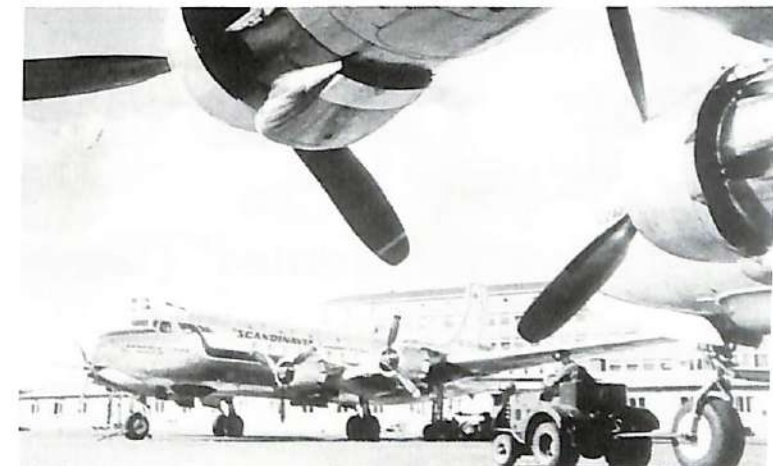
Stockholm-Bromma flygplats Douglas DC-6 försedd med tryckkabin för 48 passagerare. Marschhastighet ca 460 km/tim på 6000 m höjd. Bromma Airport-Stockholm Douglas DC-6 provided with pressure cabin for 48 passengers. Cruising speed approx 290 m/hr at 19 700 ft. altitude.
